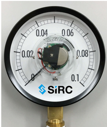
圧力計 IoT 装置 及び 表示画面
